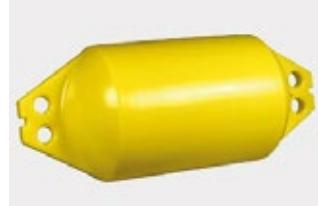
Fabriquées en polyéthylène moulé par rotation et remplie de mousse de polyuréthane à cellules fermées de 45 kg/m<sup>3</sup>. Conçue tout spécialement pour une filière de moules. Nous fabriquons des bouées à anses doubles très renforcées. Spécialement conçues pour amarrer la ligne-mère avec leurs 2 supports sur chaque côté. Ces derniers donnent de la stabilité aux bouées quand il y a de la houle et évite les balancements dans des lignes de moules.
